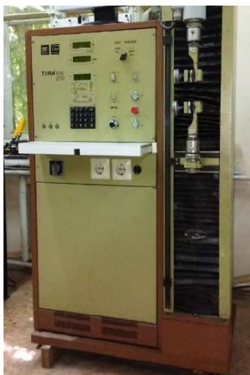
Рис. 3 Машина TIRAtest-2151 для випробування на розтяг
